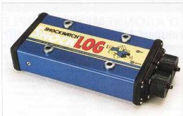
Shocklog : caractéristiques : accéléromètres de 0,2 à 100 G (250 en option), température de -40 à +85°C, humidité 0 à 100 %, pression de 0 à 1,1 bar. Poids : 700 grammes.
